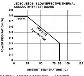
FIGURE 9. POWER DISSIPATION vs AMBIENT TEMPERATURE
