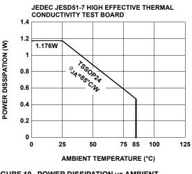
FIGURE 10. POWER DISSIPATION vs AMBIENT TEMPERATURE
