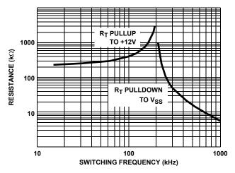
FIGURE 1. R<sub>T</sub> RESISTANCE vs FREQUENCY
