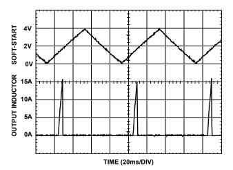
FIGURE 4. OVERCURRENT OPERATION
