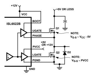
FIGURE 10. UPPER GATE DRIVE - DIRECT  $V_{CC}$  DRIVE OPTION
