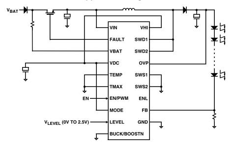
FIGURE 40. AUTOMOTIVE MINIMUM BOM BOOST MODE APPLICATION
