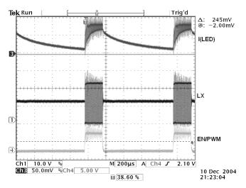
FIGURE 32. OPERATION WITH NO ENL CONTROLLED FET
