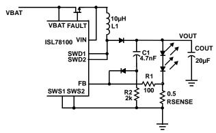
FIGURE 30. EXTERNAL SOFT-START CIRCUIT
