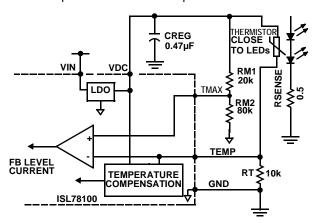
FIGURE 34. OVER-TEMPERATURE CIRCUIT
