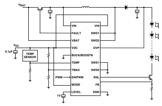
FIGURE 27. TYPICAL BOOST MODE APPLICATION CIRCUIT
