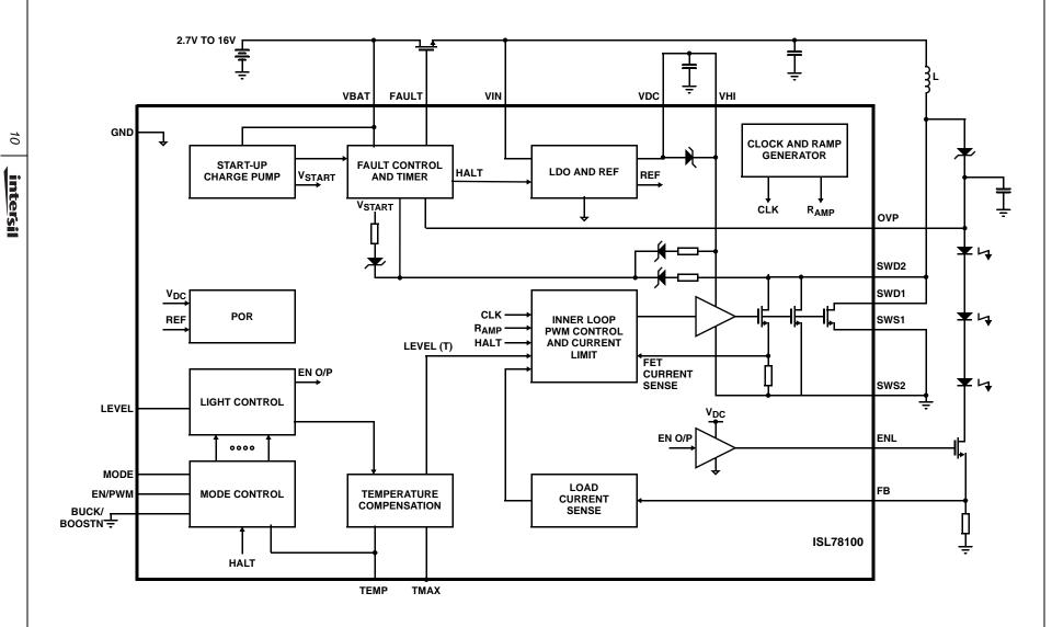
FIGURE 28. ISL78100 BLOCK DIAGRAM
