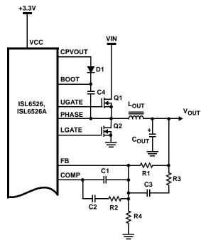
FIGURE 2. OUTPUT VOLTAGE SELECTION
