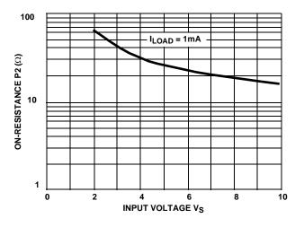
FIGURE 2. ON-RESISTANCE SWITCH P2 AS A FUNCTION OF INPUT VOLTAGE  $V_{\rm S}$
