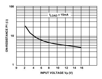
FIGURE 1. ON-RESISTANCE SWITCH P1 AS A FUNCTION OF INPUT VOLTAGE  $V_{\mbox{\scriptsize P}}$
