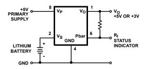
FIGURE 7. ICL7673 BATTERY BACKUP CIRCUIT
