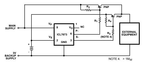
FIGURE 11. HIGH CURRENT BATTERY BACKUP SYSTEM
