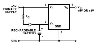
FIGURE 8. APPLICATION REQUIRING RECHARGEABLE BATTERY BACKUP
