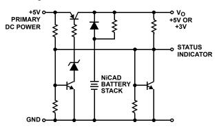
FIGURE 6. DISCRETE BATTERY BACKUP CIRCUIT
