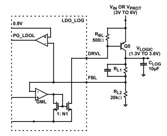
FIGURE 25. VLOGIC FUNCTIONAL BLOCK DIAGRAM
