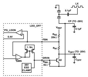
FIGURE 24. VOFF FUNCTIONAL BLOCK DIAGRAM
