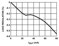
FIGURE 11.  $V_{ON}$  LOAD REGULATION
