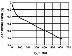
FIGURE 13. VLOGIC LOAD REGULATION
