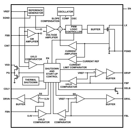
FIGURE 20. BLOCK DIAGRAM
