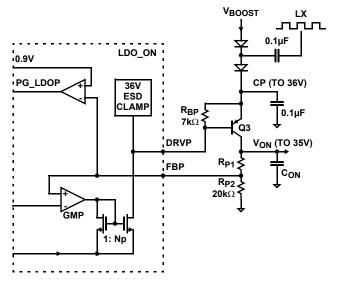
FIGURE 23. VON FUNCTIONAL BLOCK DIAGRAM
