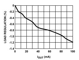
FIGURE 12.  $V_{\mbox{OFF}}$  LOAD REGULATION
