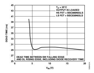
Figure 14. Dead Time vs. V<sub>IN</sub>
