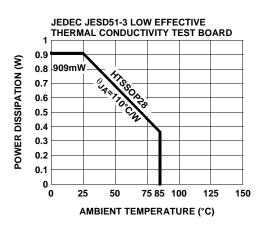
FIGURE 11. POWER DISSIPATION VS AMBIENT TEMPERATURE
