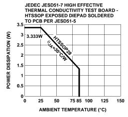
FIGURE 12. POWER DISSIPATION VS AMBIENT TEMPERATURE
