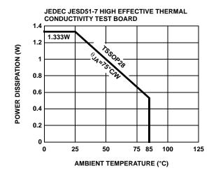
FIGURE 10. POWER DISSIPATION VS AMBIENT TEMPERATURE
