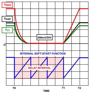
FIGURE 3. V<sub>DDQ</sub> OVERCURRENT PROTECTION AND V<sub>TT</sub>/V<sub>AGP</sub> LDO UNDER VOLTAGE PROTECTION RESPONSES
