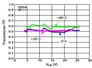
FIGURE 12. V<sub>HEADROOM</sub> vs V<sub>IN</sub> vs TEMPERATURE AT 20mA
