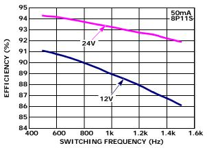
FIGURE 6. EFFICIENCY vs SWITCHING FREQUENCY
