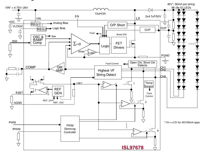
FIGURE 2. ISL97678 BLOCK DIAGRAM
