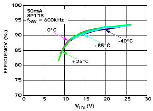
FIGURE 3. EFFICIENCY vs V<sub>IN</sub> vs TEMPERATURE AT
