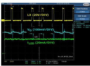
FIGURE 14. V<sub>OUT</sub> RIPPLE VOLTAGE
