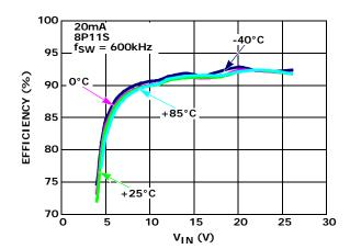
FIGURE 4. EFFICIENCY vs V<sub>IN</sub> vs TEMPERATURE AT 20mA
