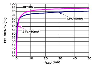
FIGURE 5. EFFICIENCY vs I<sub>LED</sub>
