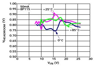
FIGURE 11. V<sub>HEADROOM</sub> vs V<sub>IN</sub> vs TEMPERATURE AT 50mA
