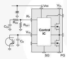
Figure 24. External Soft-Start Circuit
