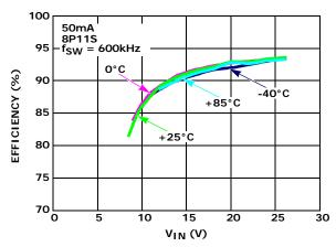
FIGURE 3. EFFICIENCY vs  $V_{\mbox{\footnotesize{IN}}}$  vs TEMPERATURE AT 50mA
