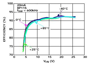
FIGURE 4. EFFICIENCY vs  $V_{IN}$  vs TEMPERATURE AT 20mA
