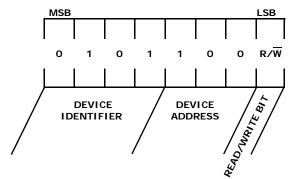
FIGURE 29. SLAVE ADDRESS BYTE DEFINITION
