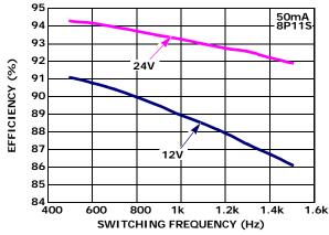
FIGURE 6. EFFICIENCY vs SWITCHING FREQUENCY
