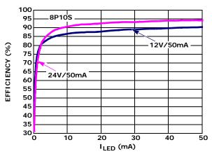
FIGURE 5. EFFICIENCY vs I<sub>LED</sub>
