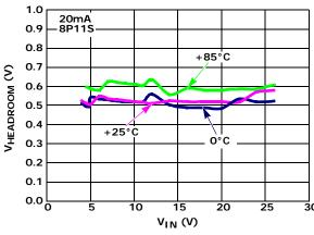
FIGURE 12.  $V_{\mbox{\scriptsize HEADROOM}}$  vs  $V_{\mbox{\scriptsize IN}}$  vs TEMPERATURE AT 20mA
