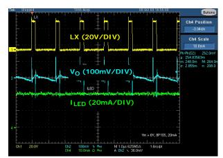
FIGURE 14. V<sub>OUT</sub> RIPPLE VOLTAGE
