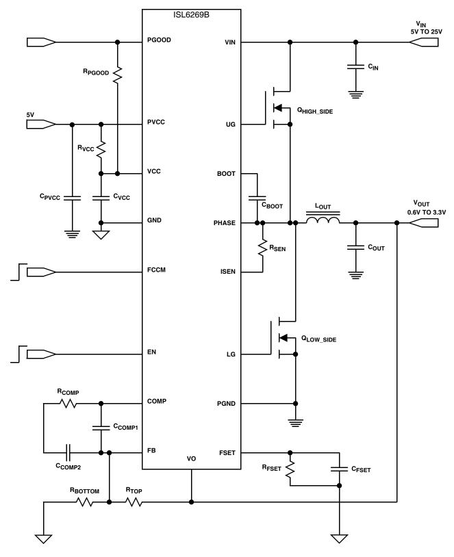
FIGURE 2. ISL6269B TYPICAL APPLICATION SCHEMATIC
